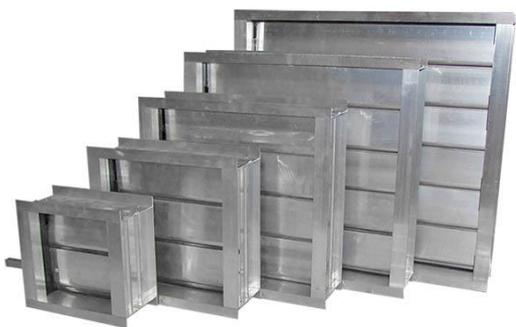
Клапан состоит из прямоугольного корпуса и установленных в него жалюзи, которые через систему зубчатых колес поворачиваются на требуемый угол. В качестве материала для изготовления корпуса и жалюзи применяются соответствующие алюминиевые профили. Конструктивно клапан исполняется только с прямоугольным сечением.
