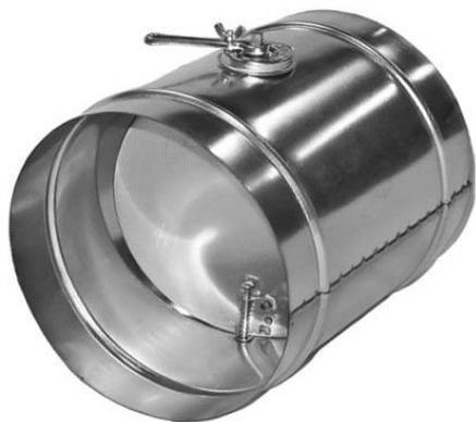
Дроссель-клапаны предназначены для регулирования расхода приточного, рециркуляционного или вытяжного воздуха в системах вентиляции и кондиционирования, рабочее давление которых не превышает 1500 Па, пропуск воздуха в закрытом положении при максимальном перепаде давления — не более 12%. В качестве исполнительного механизма используется рукоятка (ручное управление).
