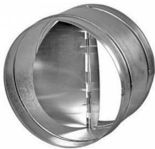
Обратные клапаны предназначены для автоматического перекрытия круглых воздуховодов при выключении вентилятора. Корпус клапана выполнен из оцинкованной стали, лопасти изготовлены из листового алюминия. Конструкция корпуса клапана позволяет крепить его к воздуховодам или другим элементам системы вентиляции с помощью хомутов. Клапан может быть установлен в любом положении, обеспечивающем при закрытии клапана плотное прилегание лопастей к корпусу.
