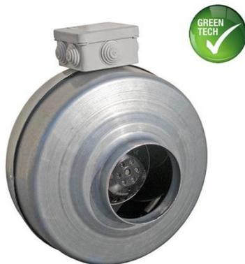
ЕС-двигатели, или электронно-коммутируемые двигатели с постоянными магнитами, - это бесщеточные двигатели постоянного тока с внешним ротором, имеющие встроенную функцию управления и с возможностью непосредственного подключения к сети переменного тока. В отличие от традиционных двигателей, с трансформаторной или электронной регулировкой частоты оборотов, в ЕС-двигателях оптимальная и эффективная работа на любых оборотах обеспечивается электронной (бесконтактной) коммутацией.
